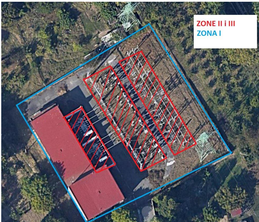
СЛИКА 1 – ПРИКАЗ ТРАФОСТАНИЦЕ ИЗ ВАЗДУХА СА ЗОНОМ 1 У ТС ОТВОРЕНОГ ТИПА
